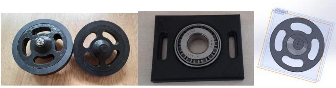
Şekil 10. Topa temas eden kauçuk halkanın mekanizmaya rulman yardımıyla sabitlenmesi.
