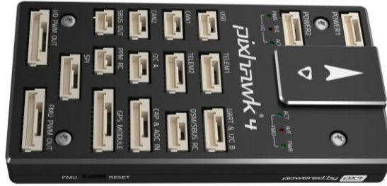
Şekil 3.13. Uçuş Kontrol Kartı (Pixhawk 4)
