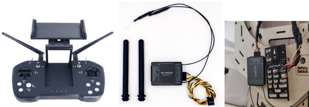
Şekil 3.17. Radyo kumanda alıcı ve verici modülü ile Skydroid T12 model, 12 kanallı radyo alıcı
