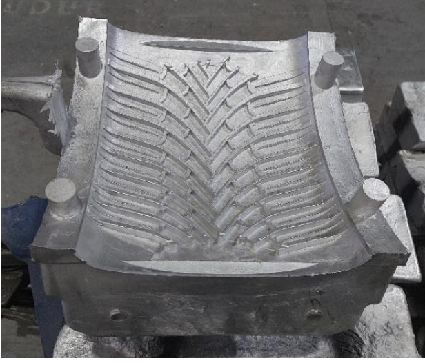
Şekil 1. Desen segmentinin görünüşü
