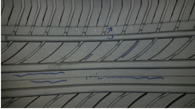
Şekil 8. Desen segmentlerinde meydana gelen porozite hatası
