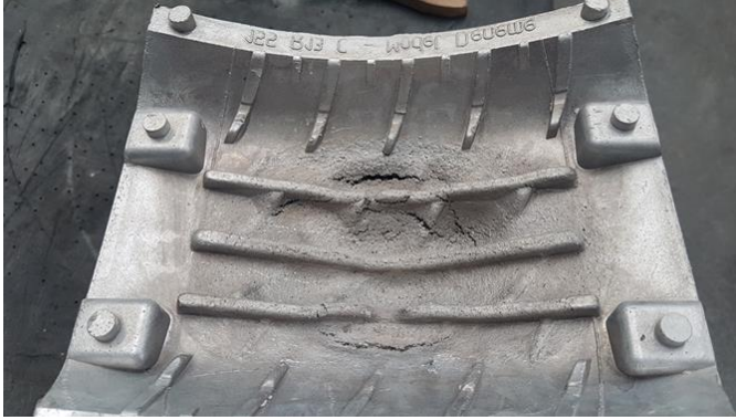
Şekil 6. Desen segmentlerinde meydana gelen sıcak yırtılma hatası
