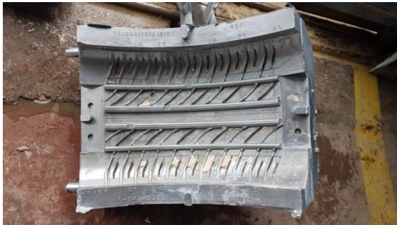
Şekil 5. Desen segmentlerinde meydana gelen alçı hatası
