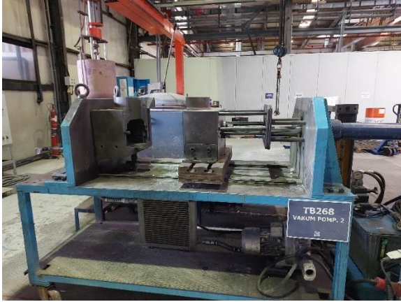
Şekil 3. Desen segmentlerinin döküm işlemlerinin yapıldığı metal kalıba döküm sistemi
