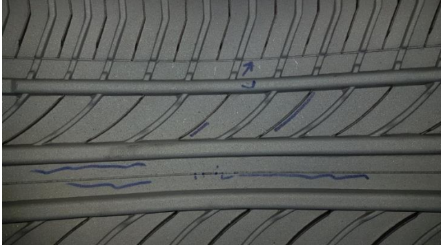
Şekil 8. Desen segmentlerinde meydana gelen porozite hatası
