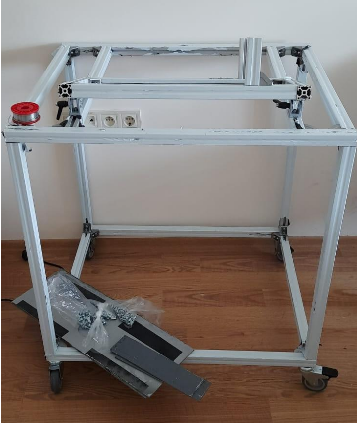
Şekil 8. Sistemin iskelet yapısının birleştirme çalışmaları
